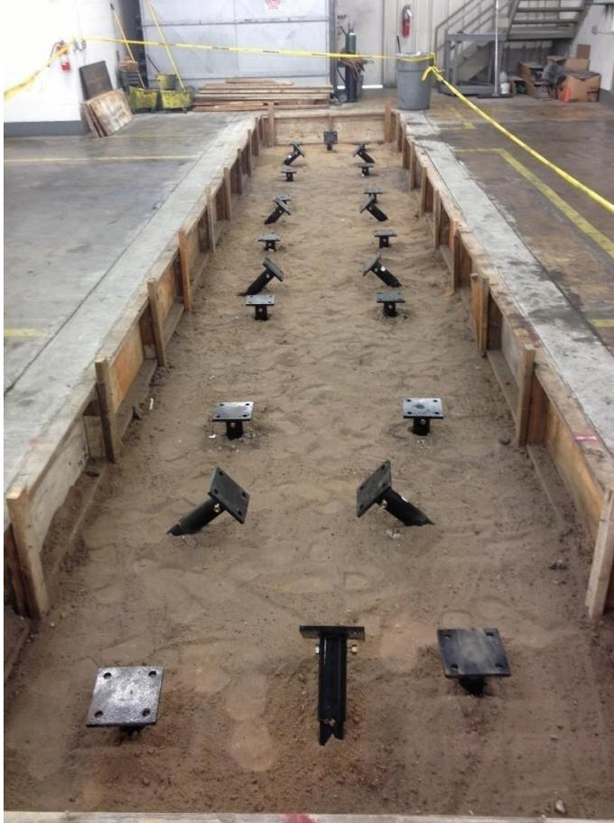
**FIGURA 19 CIMENTACIÓN CON UNA COMBINACIÓN DE PILOTES HELICOIDALES VERTICALES E INCLINADOS.**
