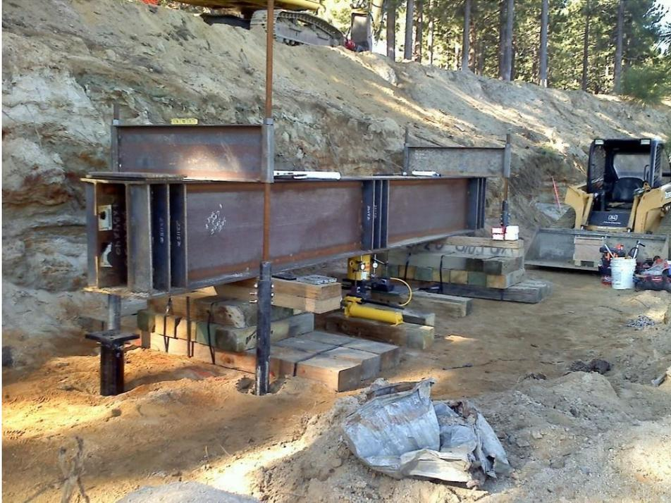
**FIGURA 28 MONTAJE TÍPICO DE ENSAYO DE CARGA A COMPRESIÓN PARA UN PILOTE HELICOIDAL**
