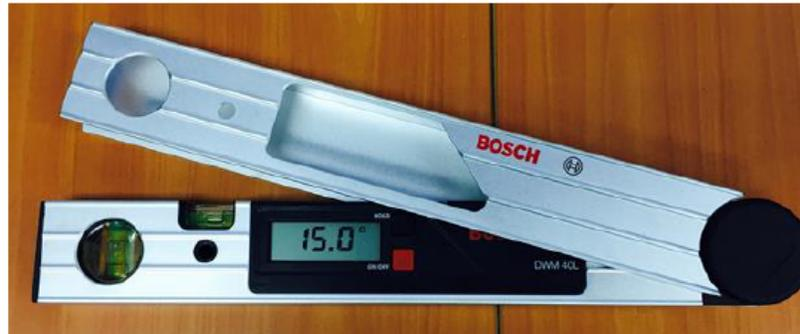
Figura 3: Herramienta de medición de ángulo digital.
